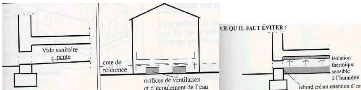
Schéma de principe d'une construction sur vide sanitaire.
